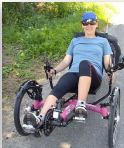
C'est un tricycle avec les deux roues avant directrices et une roue arrière motrice. Pas de problème d'équilibre, position assise très confortable. C'est une approche différente du vélo qui fait de nombreux émules dans le monde, en particulier pour la randonnée et le voyage.
